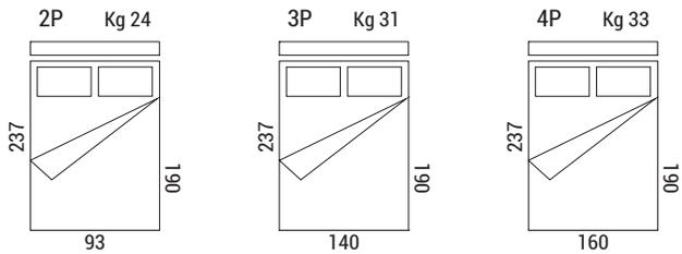
Materasso in poliuretano espanso a due pieghe, normale o ignifugo, h 12 cm, rivestito con tessuto anallergico composto da poliestere. Rete elettrosaldata di acciaio ad alta resistenza
